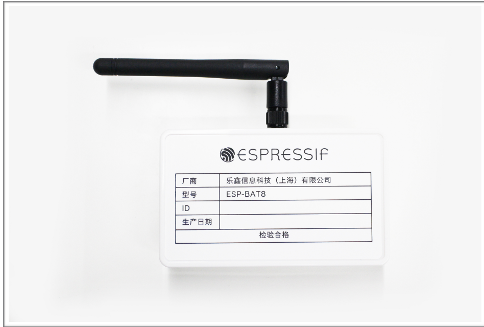
图 1-6. ESP-BAT8 信号板示意图
